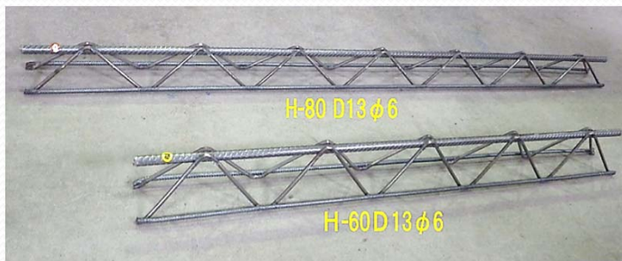
トラス筋(矢板側に溶接)
